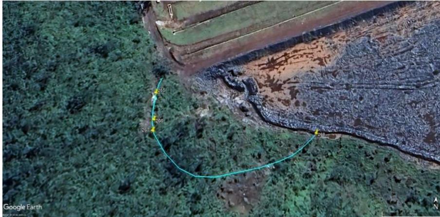
Figura 5.9 – Imagem de satélite delimitando a área onde se desenvolveu a superfície de escorregamento.
