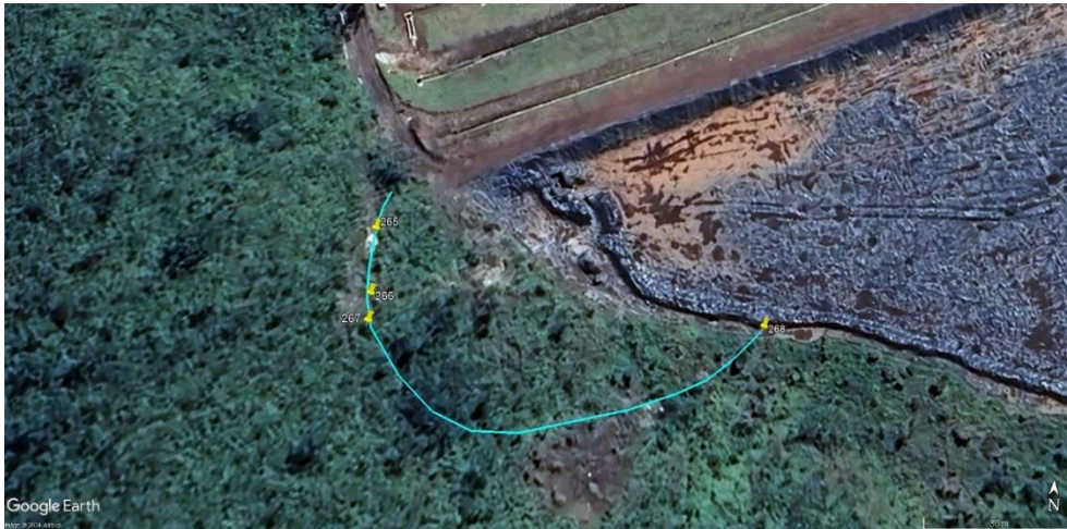
Figura 5.10 – Imagem de satélite delimitando a área onde se desenvolveu a superfície de escorregamento.
