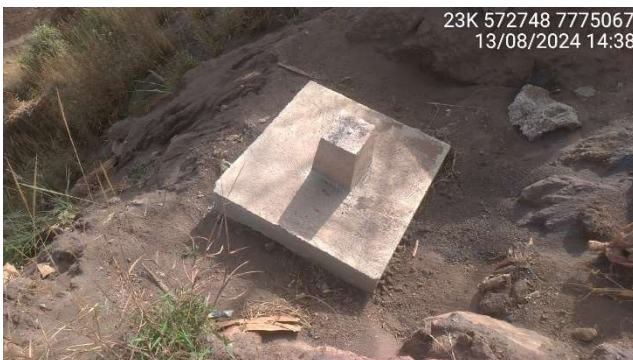
Foto 5.7 – Marco de deslocamento instalado na encosta.
