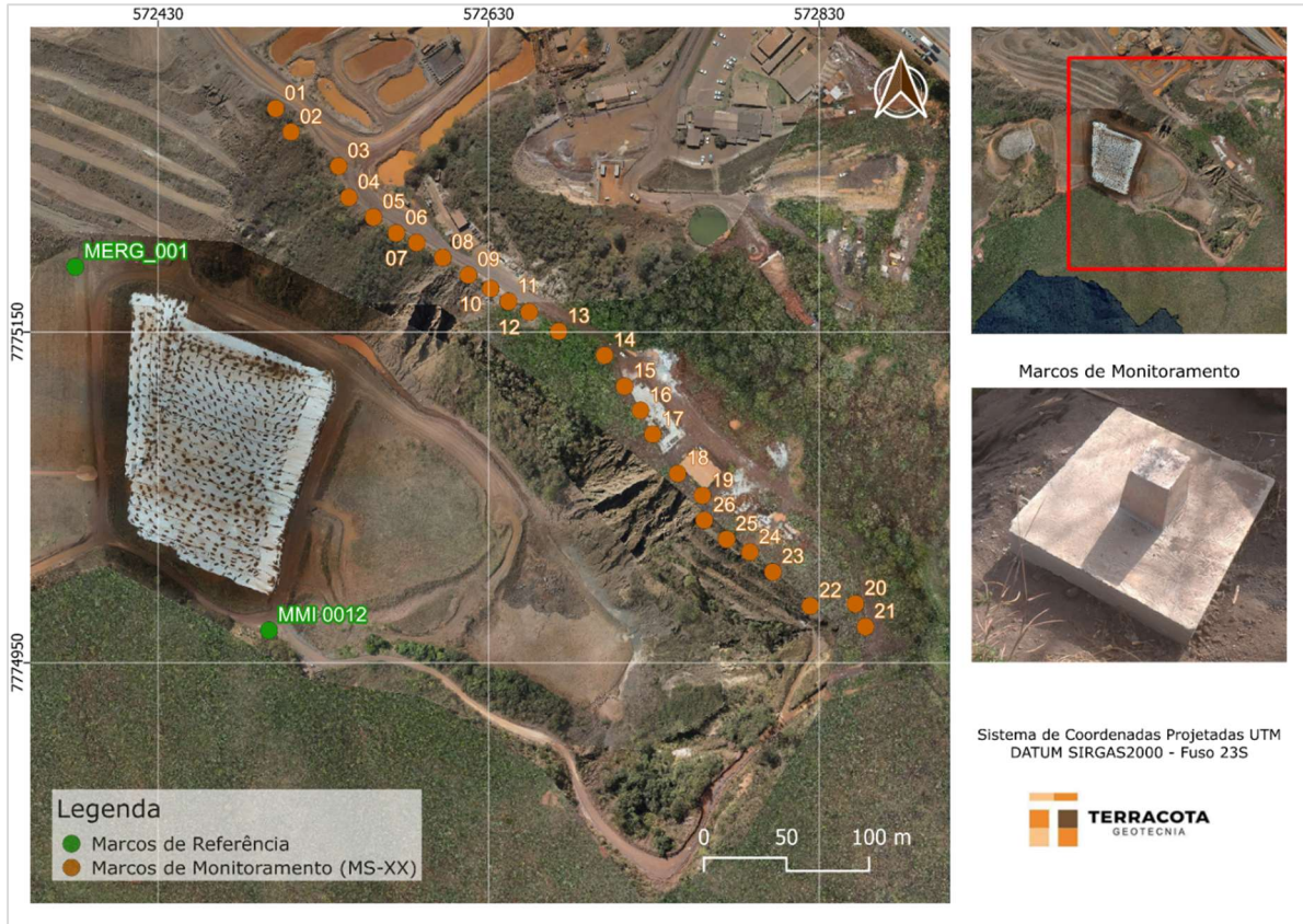
Figura 5.8 – Localização dos marcos de monitoramento da encosta na margem direita do reservatório da Barragem B1 – Mina Ipê.
