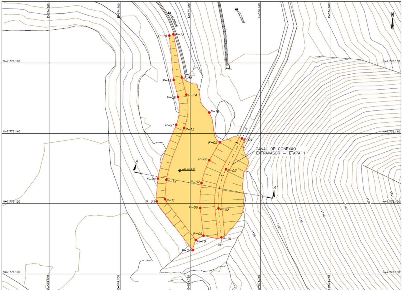
Figura 5.7 – Canal de conexão com extravasor de emergência (Etapa 1 – Fase 1) - Planta (Fonte: IPE.OP.DE.8000.GT.20.1011).
