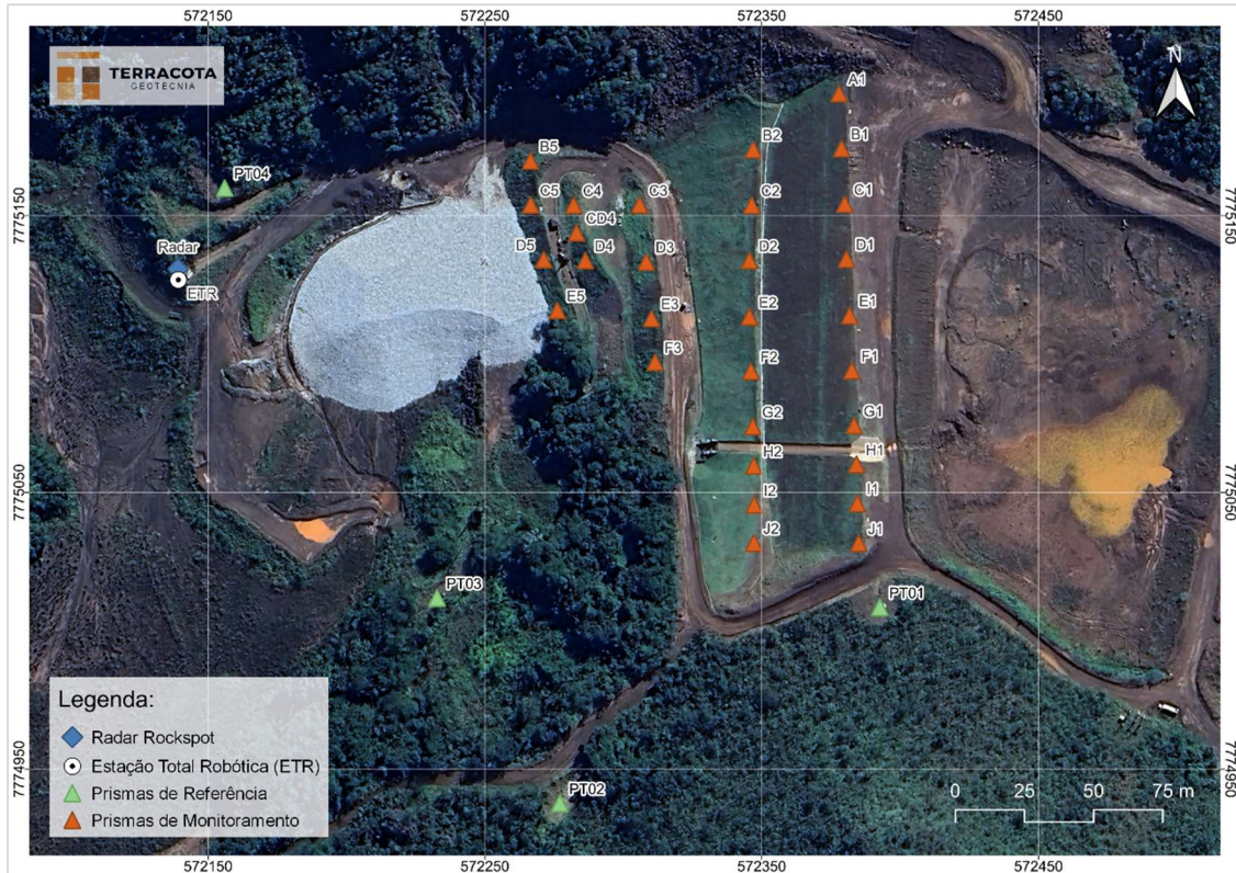
Figura 5.11 – Localização dos prismas instalados no maciço da Barragem B1 – Mina Ipê.
