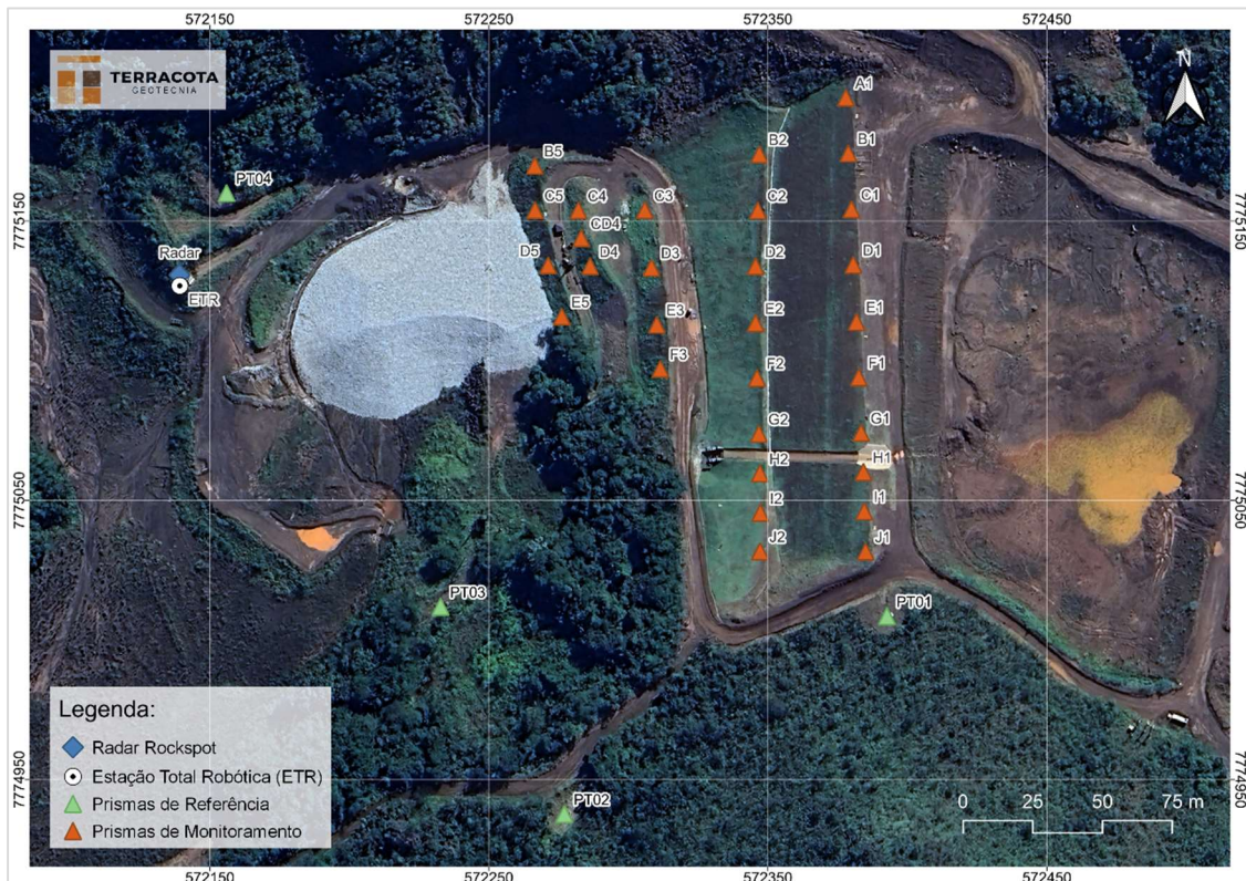
Figura 6.3 – Locação dos prismas instalados no maciço da Barragem B1 – Mina Ipê.
