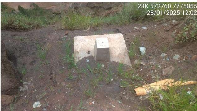
**Foto 5.8** – Marco de deslocamento instalado na encosta.
