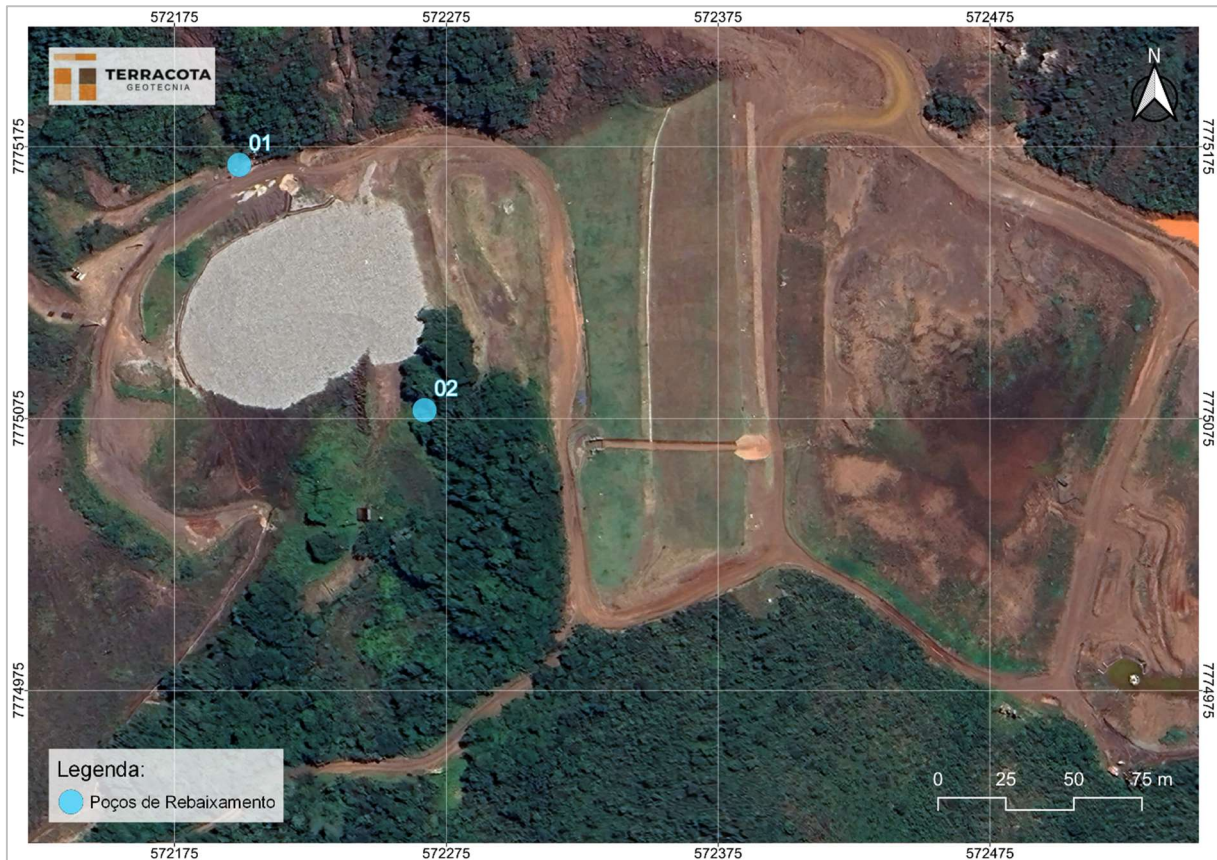
Figura 5.7 – Localização dos poços de rebaixamento.
